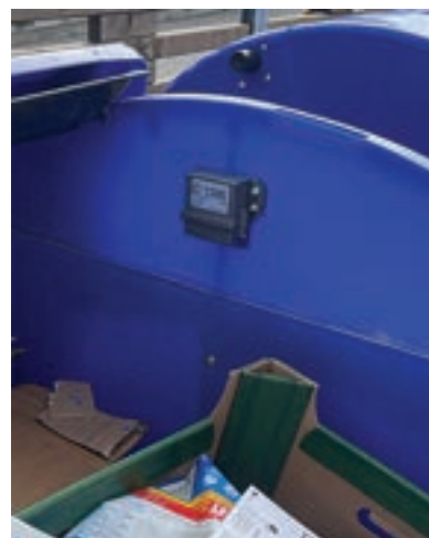
„Včeličky“ neboli senzory monitorující zaplněnost kontejneru posílají data do webové aplikace
